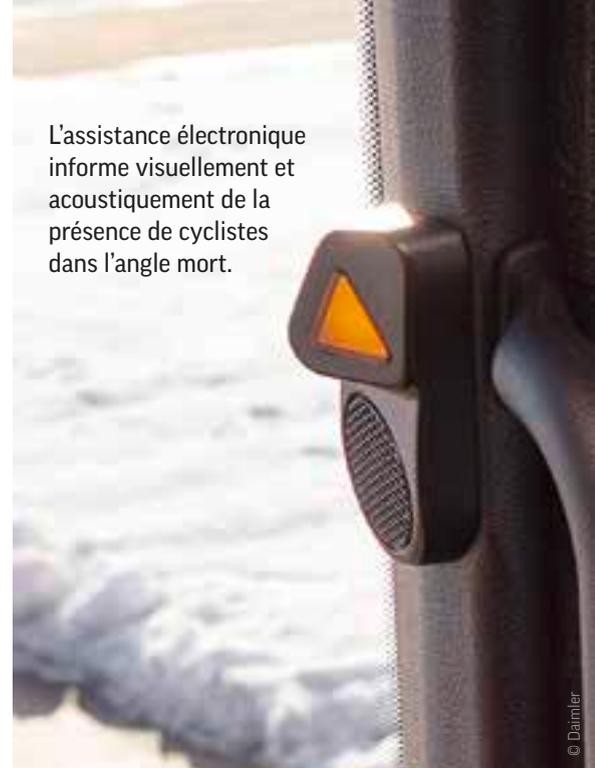
L'assistance électronique informe visuellement et acoustiquement de la présence de cyclistes dans l'angle mort.
